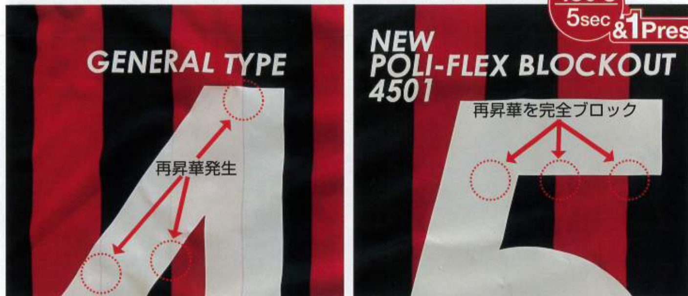
一般的な再昇華防止メディアとの比較テスト (130°C・5秒・1回プレス結果)
