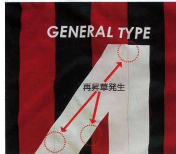
一般的な再昇華防止メディアとの比較テスト (130°C・5秒・1回プレス結果)
